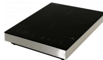
**Электрическая индукционная плита GEMPLUX GL-IP99LUX** имеет прочный пластмассовый корпус и рабочую поверхность из стеклокерамики размером 276x357x4 мм с 1 зоной нагрева, под которой находится медная катушка. Протекающий по ней высокочастотный электрический ток создает переменное магнитное поле, которое наводит вихревые электрические токи в дне наплитной посуды и разогревает ее, а следовательно, и находящиеся в ней продукты.
