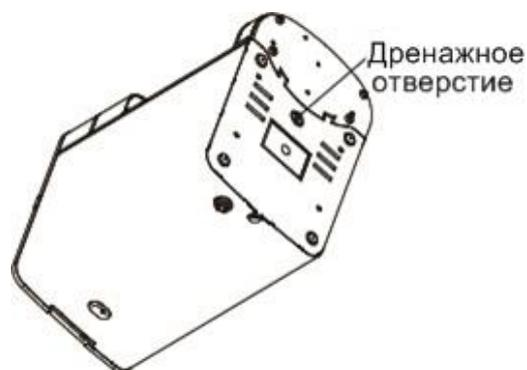
После того, как каплесборник заполнится водой, снимите его, вылейте воду и установите на место.
